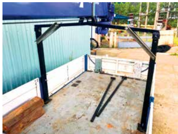
Giải pháp sáng tạo “Gia công hệ thống khung đỡ trên xe 3-1 để vận chuyển cột phục vụ công tác khắc phục thiên tai và hệ thống giá đỡ chống rung lắc cho cần cầu khi xe tự hành” của nhóm tác giả Bùi Tấn Trung và Lê Văn Trí (Điện lực Đông Giang), Nguyễn Văn Tuấn (Văn phòng).
